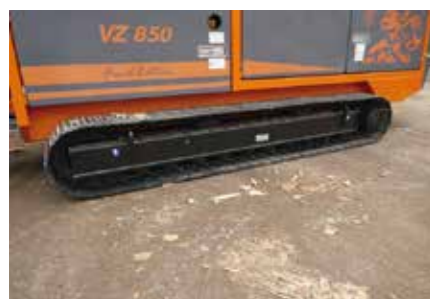
Zwei-Wellen-System, starker Volvo-Motor, Kettenlaufwerk und Überbandmagnet sind wichtige Details des VZ 850 DK.
